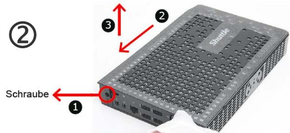
Entfernen Sie die Gehäusedeckel auf beiden Seiten des XS35.
