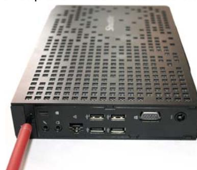
Montieren Sie wieder die beiden Gehäusedeckel mit einer Schraube.
