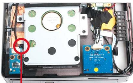
Drehen Sie XS35 herum und befestigen Sie den Festplattenhalter mit einer Schraube.
