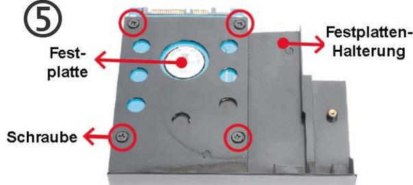
Bauen Sie die Festplatte mit Schrauben in die Halterung ein.
