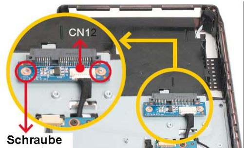
Installieren Sie die Adapterplatte mit zwei Schrauben (siehe Bild) und verbinden Sie das Kabel mit CN1.
