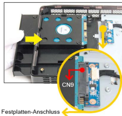
Schieben Sie die Festplatte mit der Halterung, wie mit dem roten Pfeil angedeutet, ins Gehäuse bis sich die Festplatte mit dem Anschluss CN9 verbindet.
