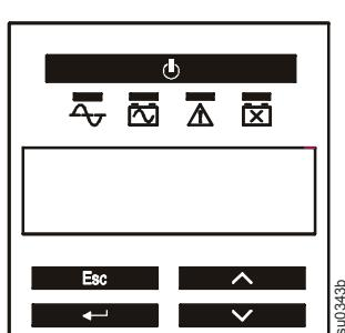
Wenn die Anzeige mit dem Batterie-Einbaudatum nicht innerhalb von zwei Minuten nach Einbau der neuen Batterie angezeigt wird, navigieren Sie mit den Pfeiltasten zu folgender Option: **Main Menu (Hauptmenü) > Configuration > Battery Install Date (Batterie-Einbaudatum)**.
